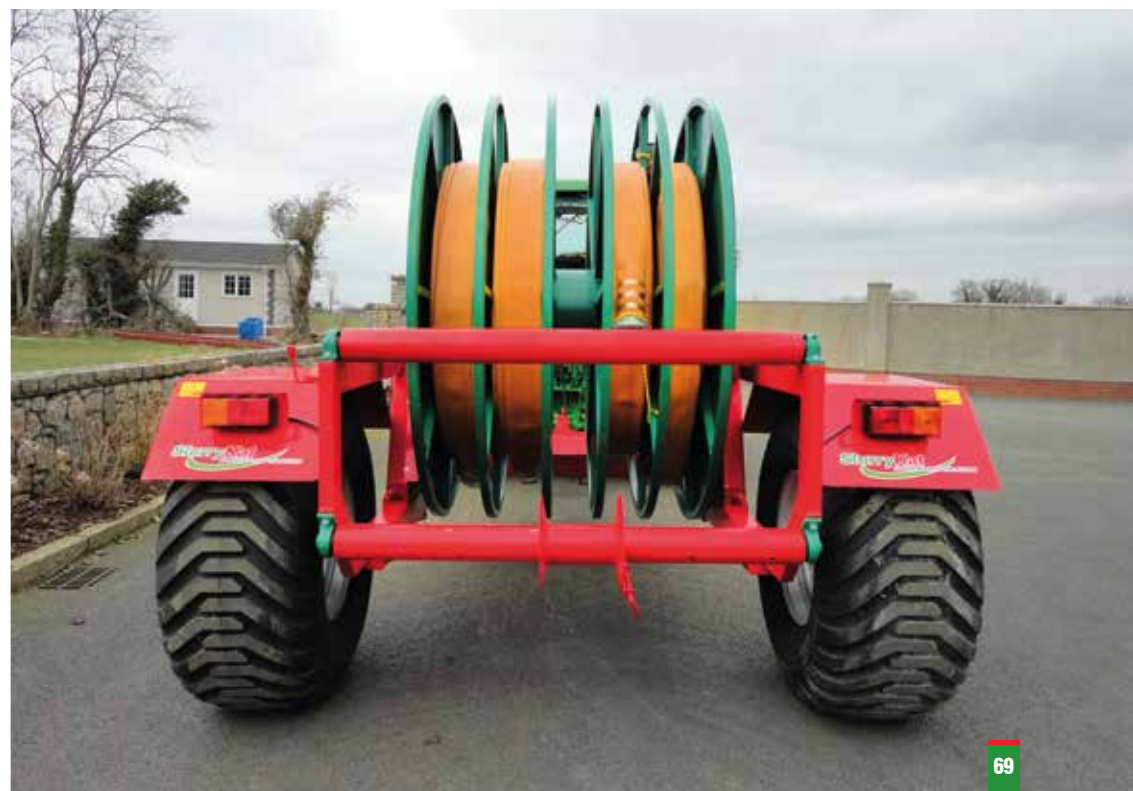
Section ouverte avec capacité de 2400 mètres
