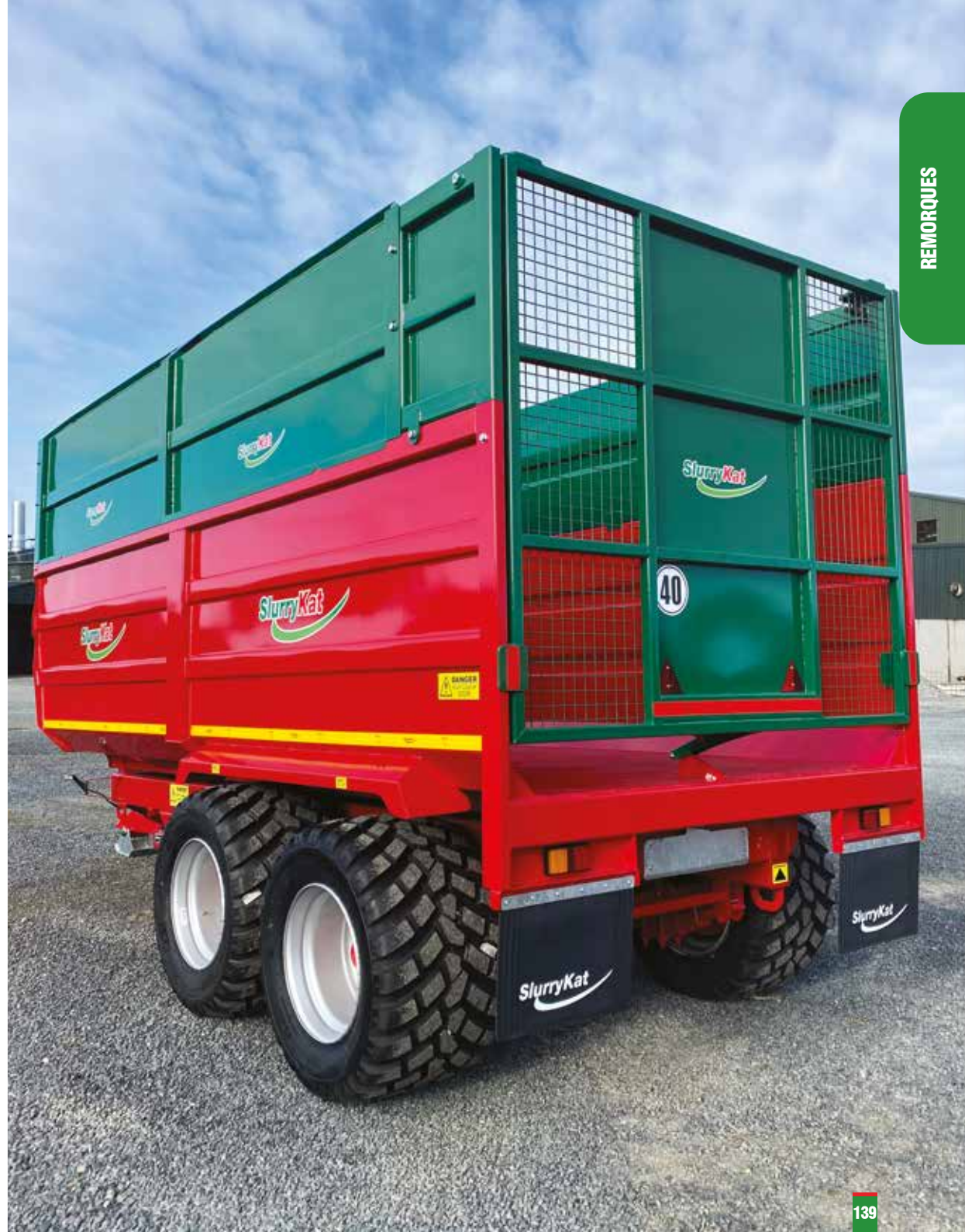
Remorque à ensilage Panterra 14 tonnes / 5,50m avec pneus basse pression en 560/60R22.5 + porte à ensilage semi-automatique
