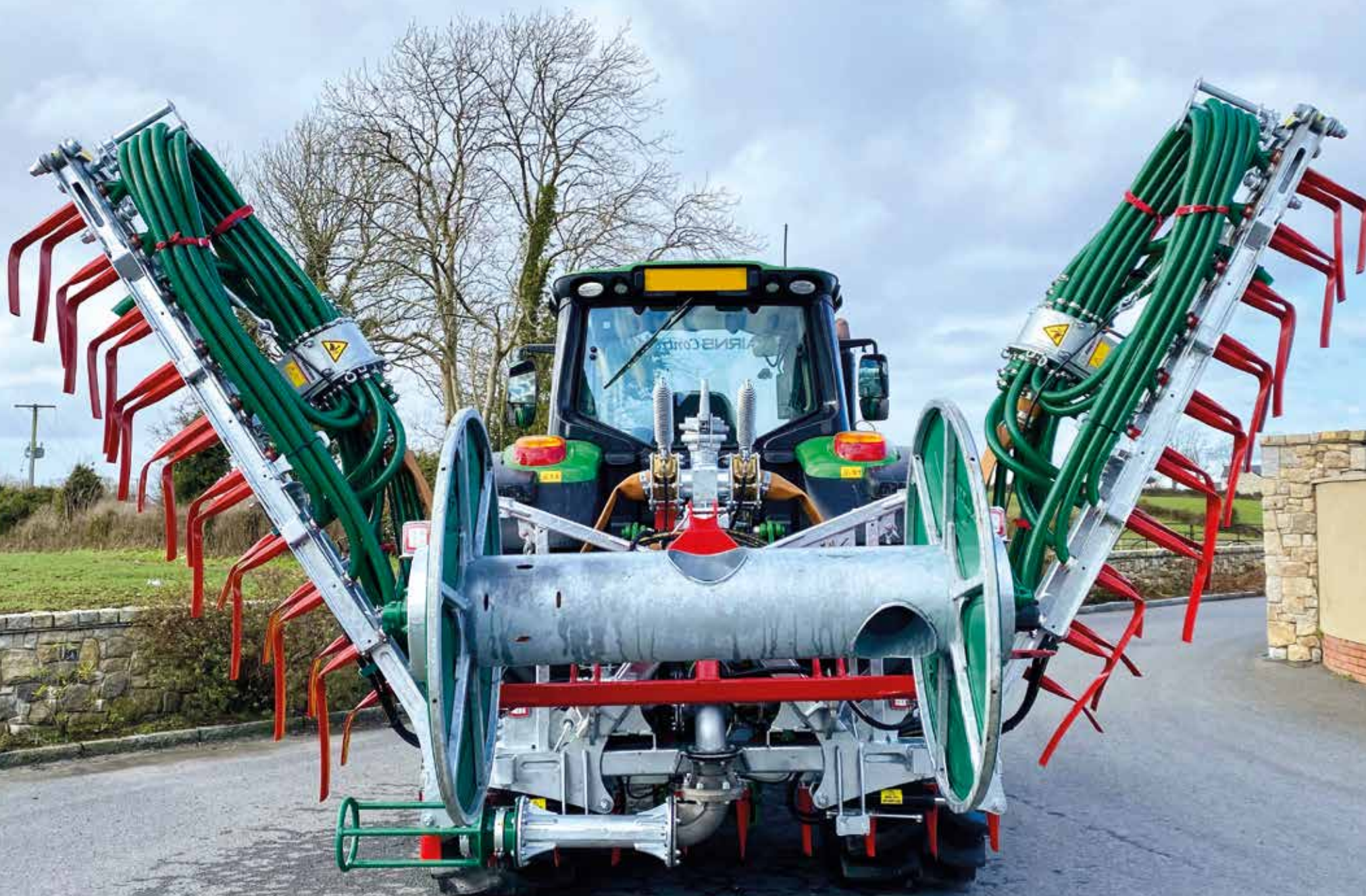
Enrouleur 800m installé sur une rampe à pendillards de 12m
