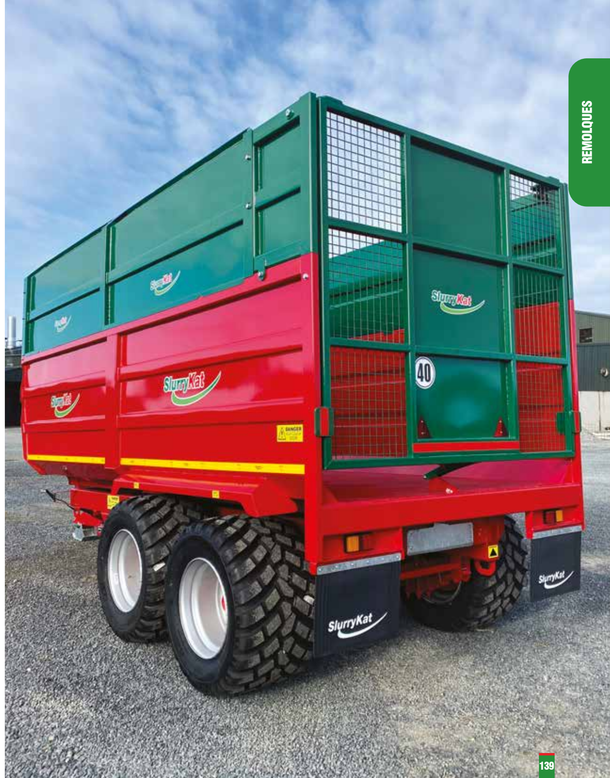
Remolque de ensilaje Panterra 14T/18ft (5.4864 metros) combinado con neumáticos de flotacion 560/60 y puerta de ensilaje semiautomática
