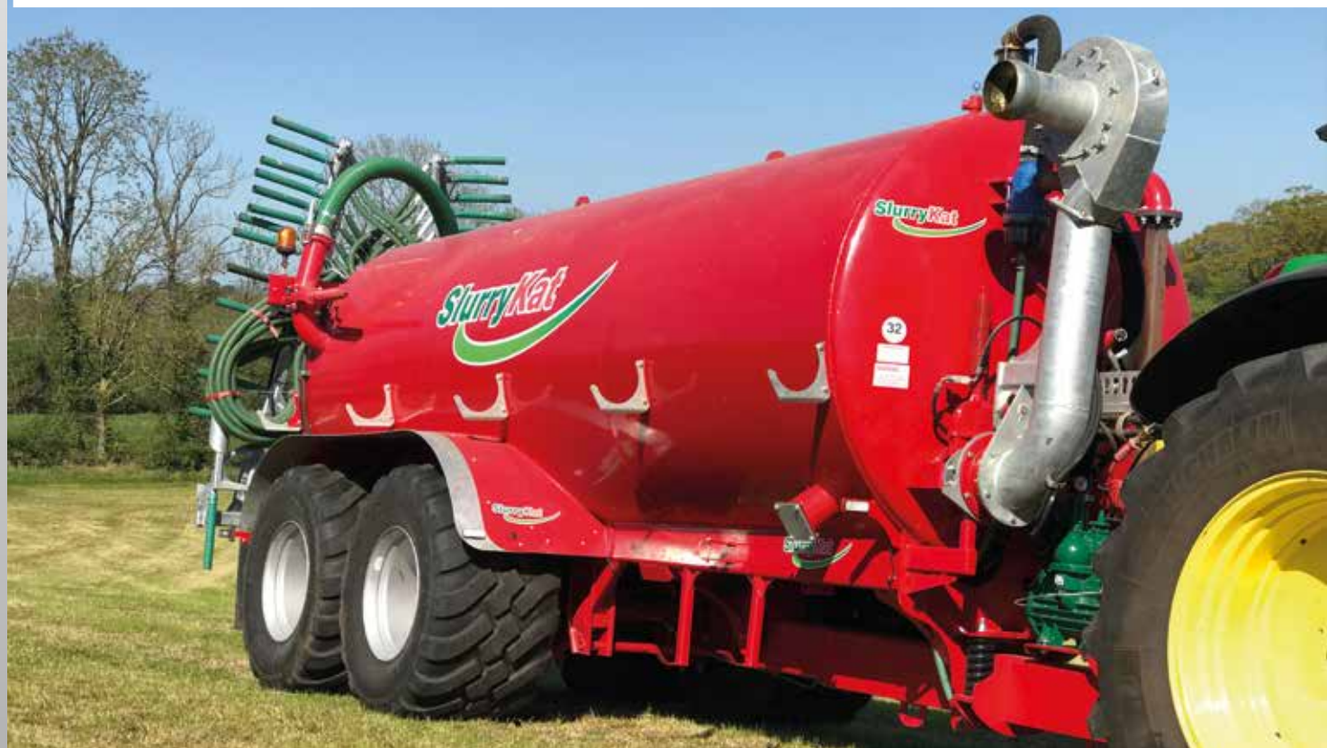
Auto llenado de 8 pulgadas combinado con cabeza y vaina turbo
