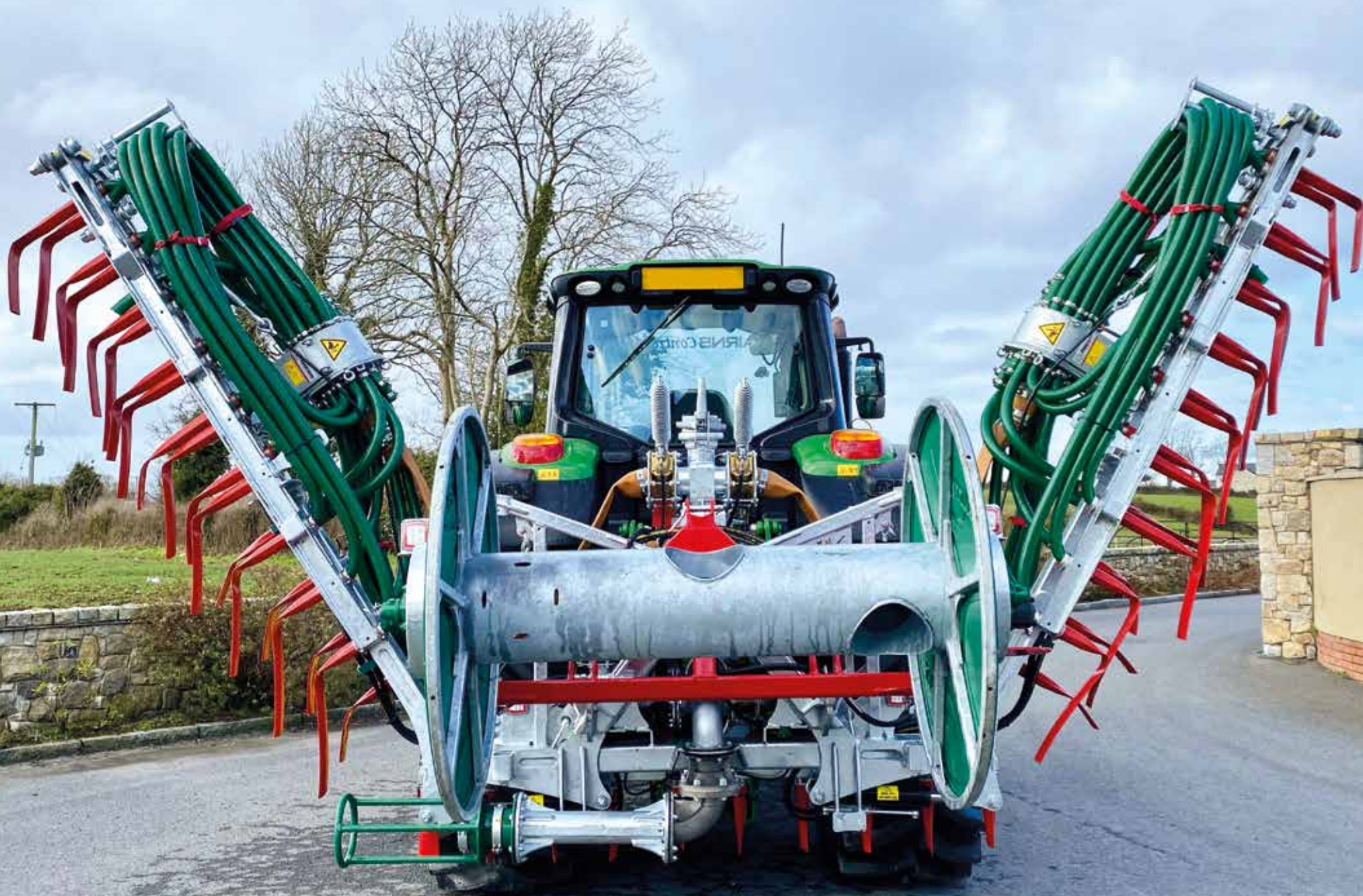
Carrete de 800 metros montado sobre barra transversal de 12 metros
