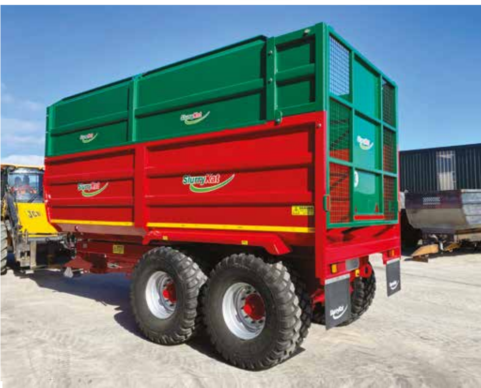
Remolque de ensilaje Panterra 14T/18ft (5.4864 metros) combinado con neumáticos de flotacion 560/60 y puerta de ensilaje semiautomática
