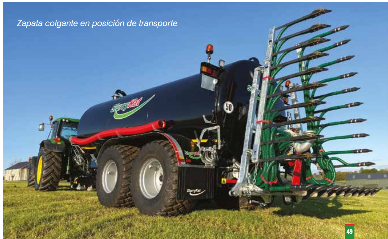
Zapata colgante de 7,5 metros
